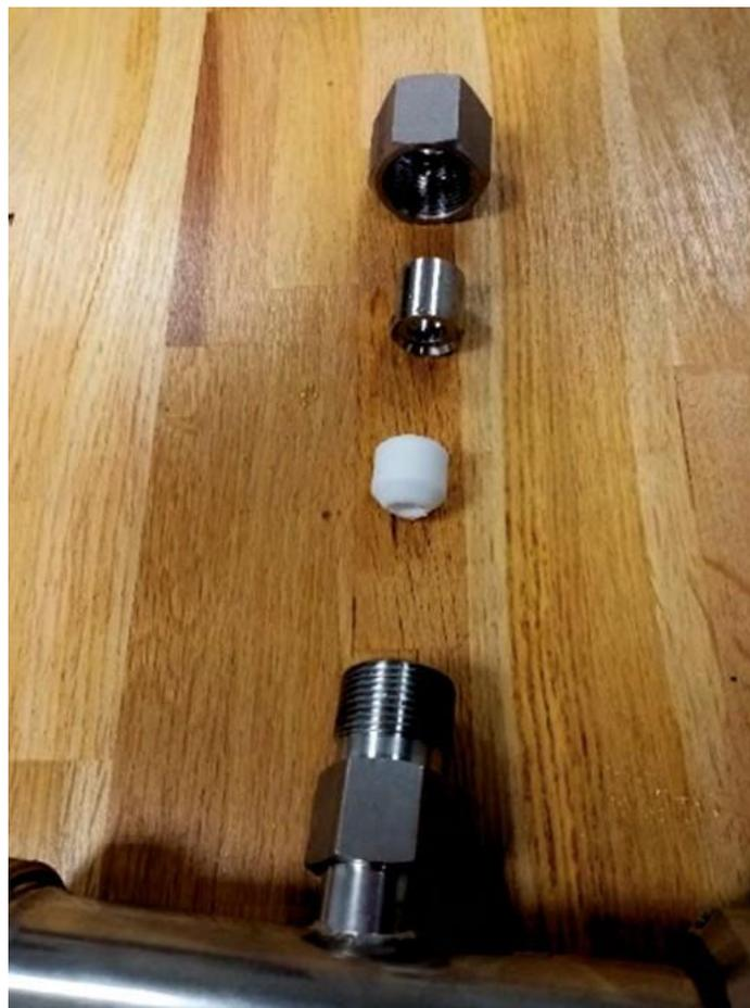
**Le serrage de l'écrou d'étanchéité doit être fait manuellement** pour éviter d'endommager la sonde. La sonde doit être positionnée de façon à dépasser à l'intérieur du tube de 5 à 10 mm.
