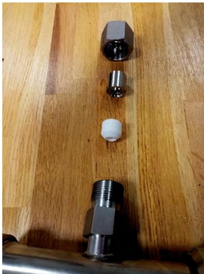
**El ajuste de la tuerca se hace manualmente** para evitar dañar la sonda, que debe sobre salir del tubo, unos 5 - 10 mm.
