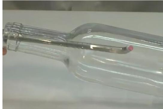
Usare la spatola per posizionare il sensore all'interno della bottiglia.
