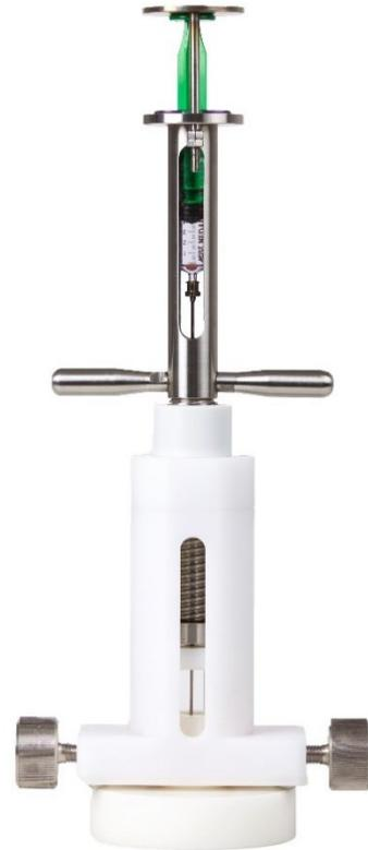
Se si esegue la perforazione di tappi in sughero naturale o in (micro)agglomerati, è possibile che piccole particelle di questi materiali possano intasare l'ago. Quando si analizzano questi tipi di chiusure, è importante munirsi di un piccolo ago per liberare il foro dell'ago del piercing system. Vedere nota applicativa 3.7.
