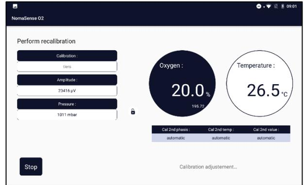
Regolare quindi l'intensità del led e i parametri di calibrazione.
