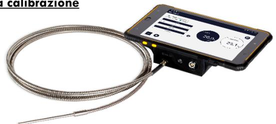
Dopo l'uso, sostituire i tappi su entrambe le estremità della sonda: quello rosso presente sulla sonda ha la funzione di proteggere il sensore dalla luce mentre quello presente sul connettore SMA evita l'infiltrazione di polvere nel connettore.
