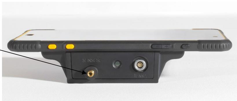
Collegare una sonda ad immersione o un cavo a fibra ottica al connettore SMA, quindi avvitare manualmente prestando attenzione a non esercitare una forza eccessiva.
