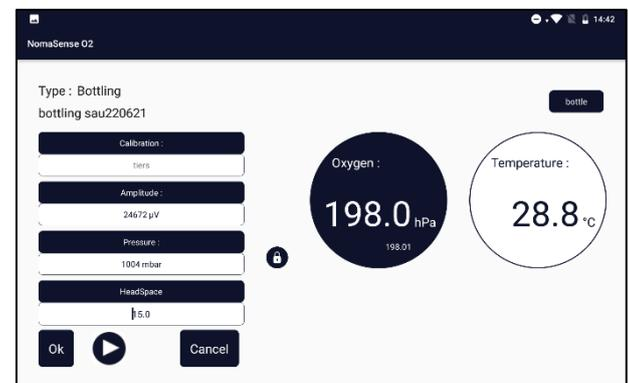
Digitare il valore del volume del cono. Il volume del cono può essere inserito anche dopo l'analisi DO o prima dell'analisi HSO.
