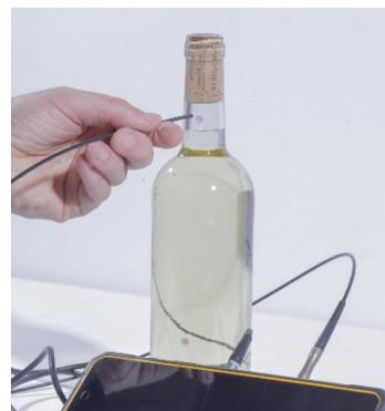
Posizionare la fibra ottica sul sensore incollato nello spazio di testa. **La sonda di temperatura deve essere posizionata in aria.** Quando il valore è stabile, l'analisi si interrompe automaticamente.
