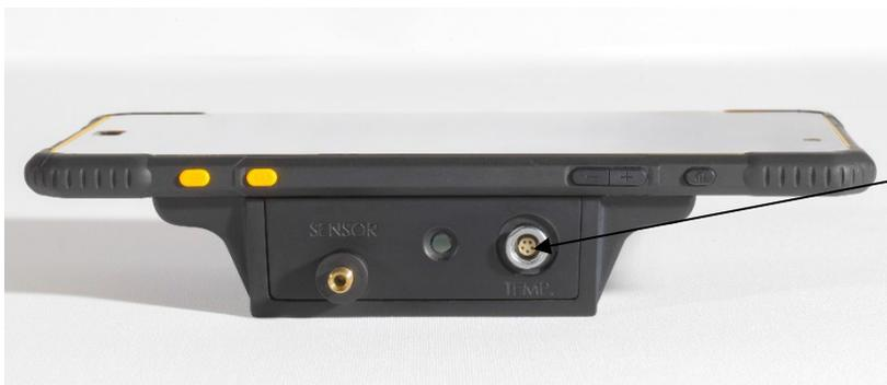
Connettore per la sonda di temperatura (PT100)
