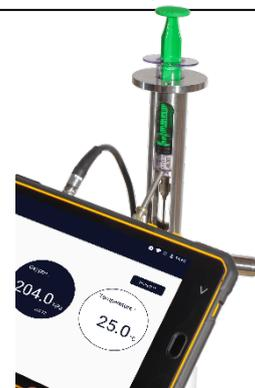
Posizionare la fibra ottica sul sensore a punto della siringa. **La sonda di temperatura deve essere posizionata in aria.** Quando il valore è stabile, l'analisi si interrompe automaticamente.
