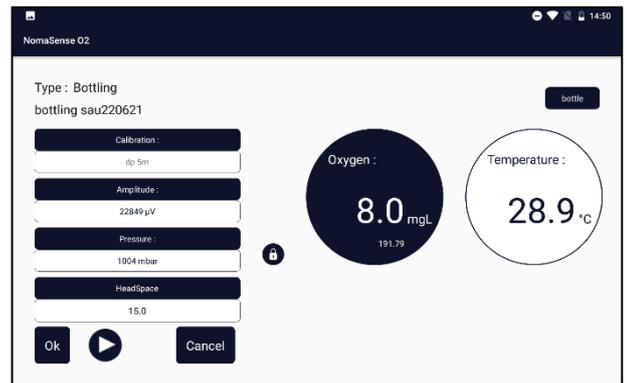
Agitare la sonda ad immersione per ottenere un tempo di stabilizzazione più breve. Quando il valore è stabile, l'analisi si interrompe automaticamente.
