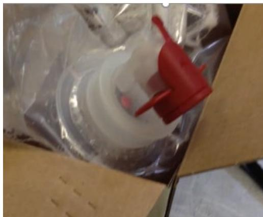
Posizionare la busta in modo che il rubinetto sia a contatto con la bolla d'aria presente nella busta. Disporre la sonda di temperatura a contatto con l'aria ambiente oppure digitare manualmente il valore della temperatura ambiente nel menu dei parametri.
