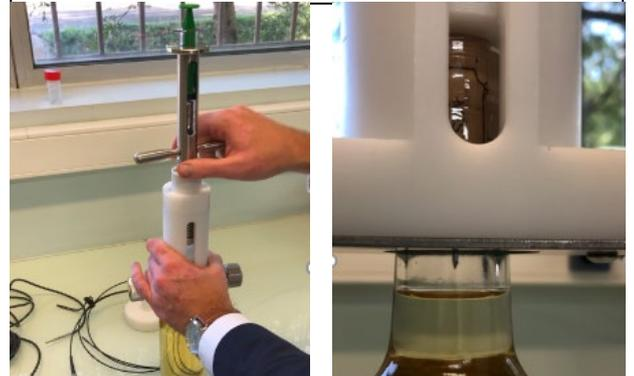
Perforare il tappo di sughero con il piercing system dispositivo di perforazione fino a quando i fori del foro dell'ago si trovano all'interno dello spazio di testa. Muovere lo stantuffo della siringa su e giù per 3-4 volte. Prelevare il volume di campione desiderato e mantenere lo stantuffo in posizione.
