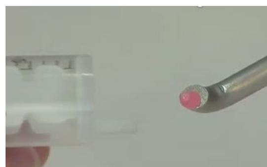
Applicare un piccolo quantitativo di colla siliconica sul sensore servendosi della siringa.
