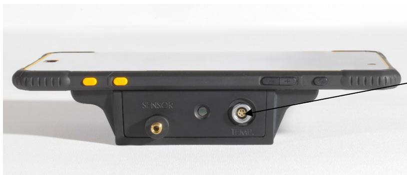
Connettore per la sonda di temperatura (PT100)
