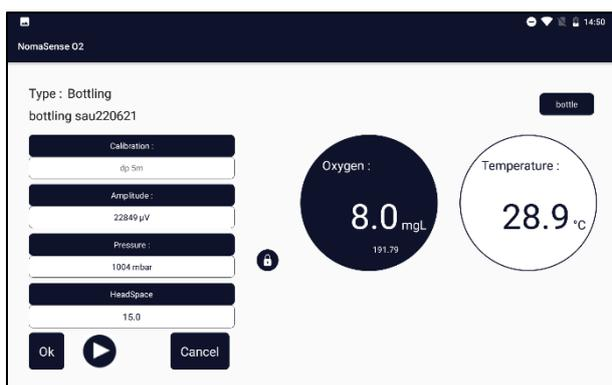
Posizionare la fibra ottica sul sensore a contatto con il vino. Quando il valore è stabile, l'analisi si interrompe automaticamente.
