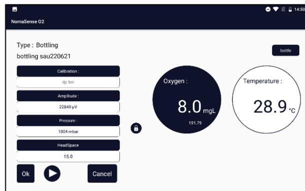
Posizionare la fibra ottica sul sensore a punto a contatto con il vino. Quando il valore è stabile, l'analisi si interrompe automaticamente.
