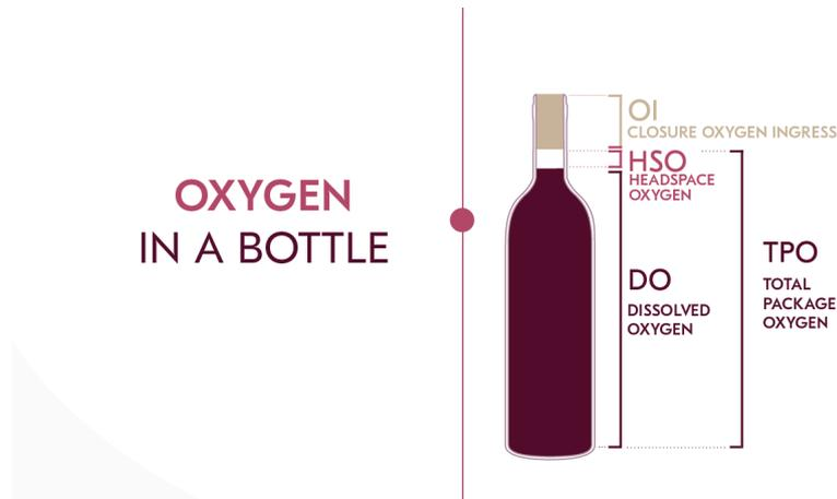
Il valore TPO rappresenta la somma della quantità di ossigeno disciolto nel vino e di quello presente nel volume dello spazio di testa (dato espresso in mg/l) in un BIB o in una bottiglia.
