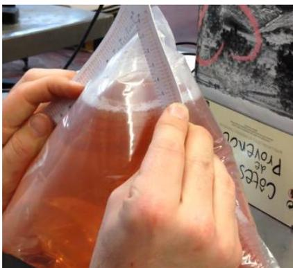
Mesurer le volume du cône. Placer le sachet sur une surface plane et appuyez-le modérément pour former le cône.
