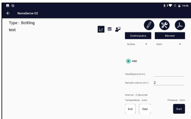
Saisir le volume de l'échantillon HS à prélever dans la seringue en mL et l'espace de tête en mm. Noter que l'espace libre peut être saisi avant la mesure HSO, après la mesure HSO ou après la mesure DO.
