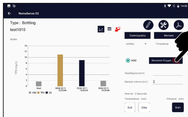
Appuyer sur l'icône de la bouteille rouge pour lancer la mesure de la DO. Récupérer un BIB de la ligne sans capteur, verser un peu de vin dans un seau et placer la sonde de température dans ce vin.
