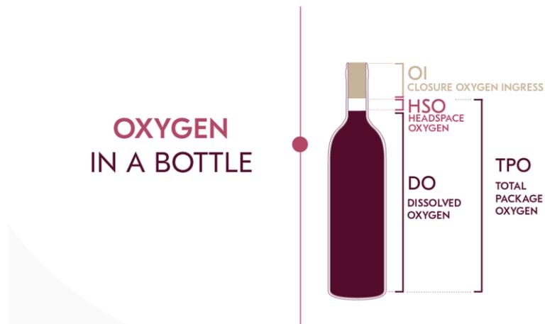
Le TPO est la somme de la quantité d'oxygène dissous et d'oxygène de l'espace tête par volume de vin (exprimée en mg/L) dans un BIB ou une bouteille.
