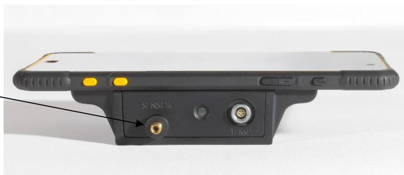
Connecter une sonde à immersion ou une fibre optique au connecteur SMA, visser manuellement et modérément.
