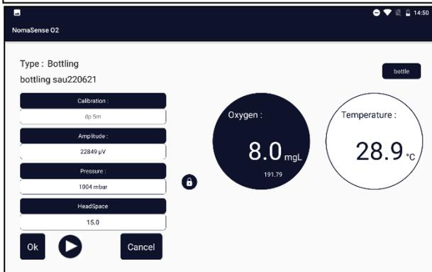
Agiter la sonde à immersion pour obtenir un temps de stabilisation plus court. Une fois que la valeur est stable, la mesure s'arrête automatiquement. À la fin de la mesure, appuyer sur OK
