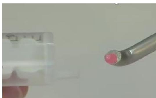
Avec la seringue, verser une petite quantité de colle silicone sur le capteur, sur la face rouge.
