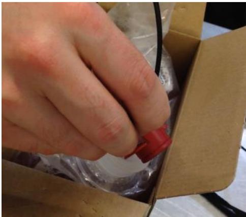
Placer la fibre optique sur le capteur d'oxygène.
