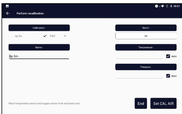
Il est possible de modifier le nom ou de créer une nouvelle calibration. Dans ce cas, la calibration avec le nom précédent est enregistrée et la calibration avec le nouveau nom correspond à la recalibration.
