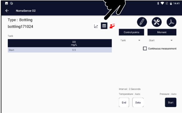
Une vue en tableau est également disponible, une ligne par moment de mesure avec DO, HSO et TPO. Le coefficient de variation s'affiche si le nombre de bouteilles est supérieur à 2 pour un moment de mesure.
