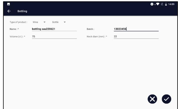
Entrer un nom pour la série, le volume des bouteilles et le diamètre du goulot d'étranglement interne (considérez le diamètre du goulot de la bouteille dans l'espace de tête de la bouteille. Il est souvent de 21 mm).
