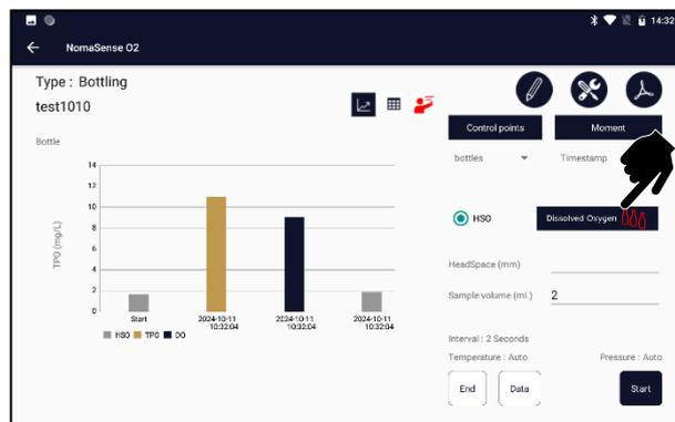
Appuyer sur l'icône « Dissolved oxygen » pour lancer la mesure de la DO. Ouvrir la bouteille, placer la sonde à immersion et la sonde de température à l'intérieur de la bouteille.
