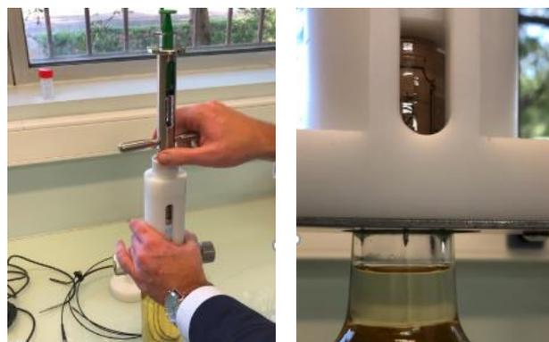
Percer le bouchon avec le Piercing System jusqu'à ce que les trous de l'aiguille soient à l'intérieur de l'espace de tête.
