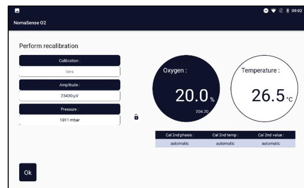
À la fin, appuyer sur OK pour enregistrer la calibration. La valeur de %O<sub>2</sub> doit être comprise entre 19,5 et 21,5 %. Sinon, un drapeau rouge apparaît à côté du nom de la calibration.
