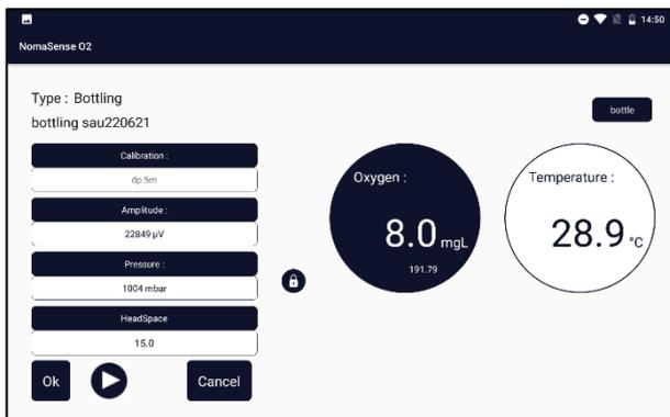
Placer la fibre optique sur le capteur de point en contact avec le vin. Une fois que la valeur est stable mesure s'arrête automatiquement. À la fin de la mesure, appuyez sur OK
