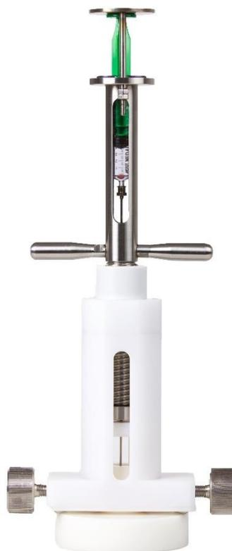
Lorsqu'elles sont utilisées pour traverser des bouchons naturels ou des (micro)agglomérés, de petites particules de liège peuvent parfois boucher l'aiguille. Lorsque vous effectuez des mesures sur ces types de bouchon, utilisez une petite aiguille pour déboucher les trous d'aiguille du piercing system. Voir la note d'application 3.7.
