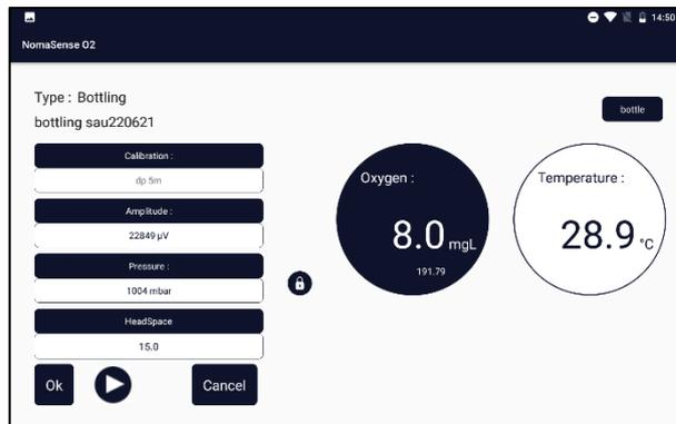
Placer la fibre optique sur le capteur d'oxygène en contact avec le vin. Une fois la valeur stable, la mesure s'arrête automatiquement.
