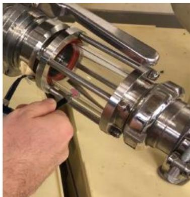
Placez la fibre optique sur le capteur ou utilisez l'adaptateur pour mesure en continu sur mireur.
