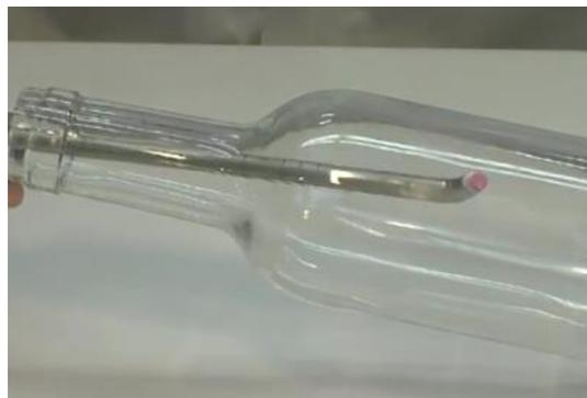
Avec la spatule, placez le 1<sup>er</sup> capteur d'oxygène dans la bouteille, face rouge contre le verre.
