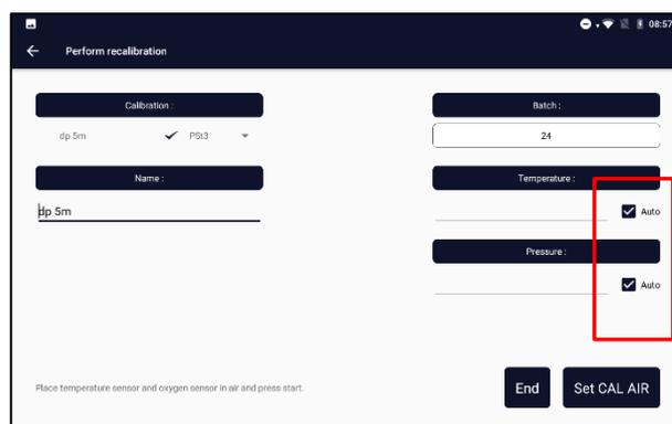
Laisser la pression et la température en mode automatique. Il est possible de saisir une valeur pour ces paramètres, mais il est préférable d'utiliser le capteur intégré pour la pression et la sonde de température. Appuyer sur « Set CAL AIR » \*
