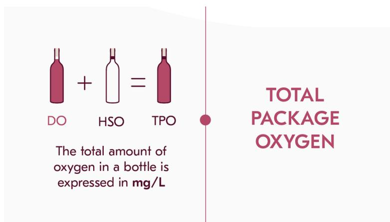
La TPO est la somme de la quantité d'oxygène dissous et d'oxygène de l'espace tête par volume de vin (exprimée en mg/L) dans un BIB ou une bouteille.
