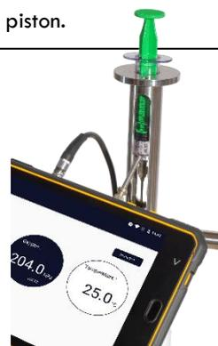
Placer la fibre optique sur le capteur d'oxygène de la seringue. La sonde de température doit être placée dans l'air. Une fois que la valeur est stable, la mesure s'arrête automatiquement.
