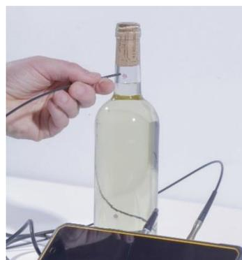
Placer la fibre optique sur le capteur d'oxygène collé dans l'espace libre. La sonde de température doit être placée dans l'air. Une fois la valeur stable, la mesure s'arrête automatiquement.
