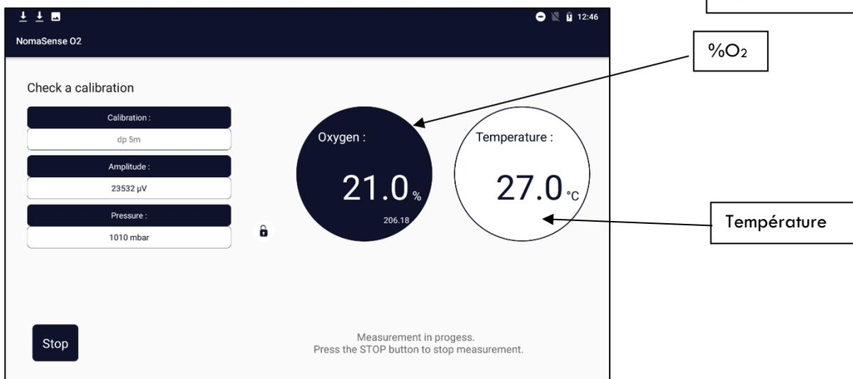
Une fois la mesure stabilisée, %O<sub>2</sub> s'affiche. Elle doit être comprise entre 20 et 22 %. Dans le cas contraire, une recalibration est nécessaire et un drapeau rouge apparaît à côté du nom de l'étalonnage. Appuyez sur « OK » pour quitter.
