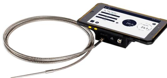
Après utilisation, replacer les protections aux deux extrémités de la sonde : la protection rouge sur la sonde elle-même pour protéger le capteur de la lumière et celui sur le connecteur SMA pour éviter à la poussière d'entrer dans le connecteur.
