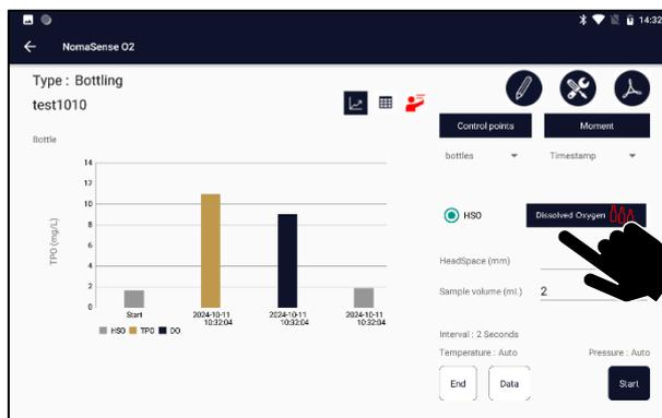
**Prendre une bouteille sur la ligne (sans capteur), l'ouvrir et placer la sonde de température à l'intérieur. Appuyez sur l'icône « Dissolved oxygen » pour lancer la mesure de la DO.**
