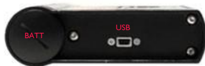
Fig. 3 Panel inferior del transmisor
