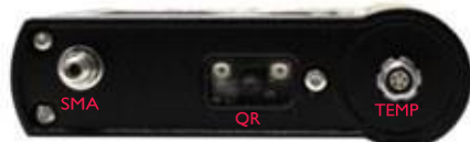
Fig. 2 Panel superior del transmisor
