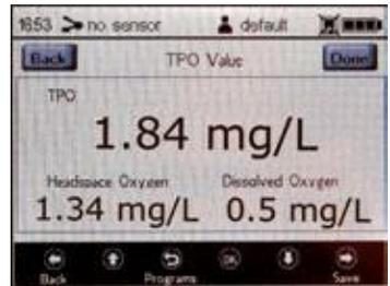
Abb. 11 Anzeige TPO-Messung
