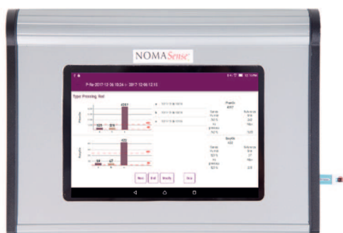
Figura 1. Analizzatore elettrochimico utilizzato per lo studio, costituito da un potenziostato portatile e elettrodi miniaturizzati
