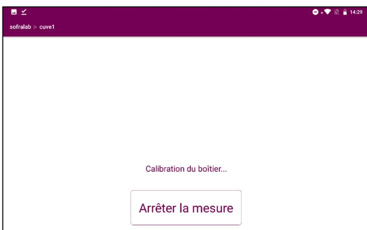
La mesure commence par une phase de **détection** de l'électrode et de **calibration** du boîtier.
