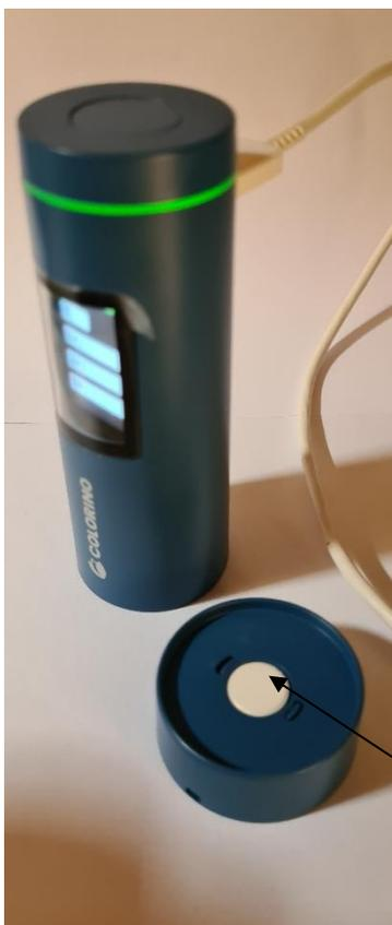
Couvercle de protection de l'objectif et de calibration. La céramique blanche permet la calibration : ne pas toucher avec les doigts la nettoyer à l'eau tiède savonneuse avec un chiffon non pelucheux uniquement si besoin.
